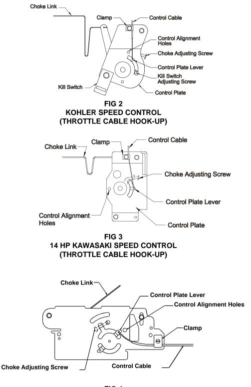
FIG 4 15 & 17 HP KAWASAKI SPEED CONTROL (THROTTLE CABLE HOOK-UP)
